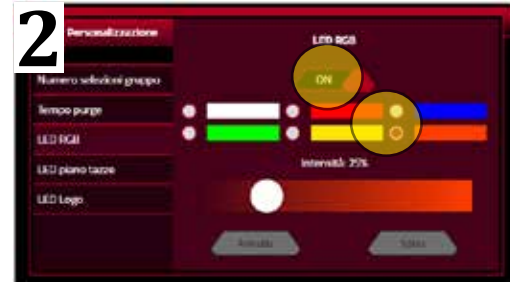
Il cursore in alto permette di accendere o spegnere i led RGB. Selezionare il colore desiderato.
